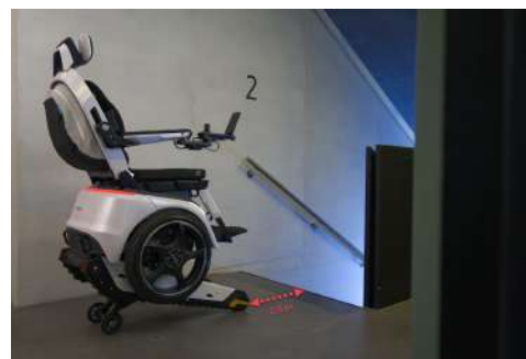
Abbildung 52. Aktiviere den Fahr- oder den Treppenmodus immer mit mindestens 50 cm Abstand zur oberen Treppenkante!
