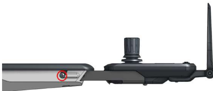
Abbildung 16. Zu lösende Schrauben, um die Position der Steuerkonsole zu verstellen (beidseitig lösen)
