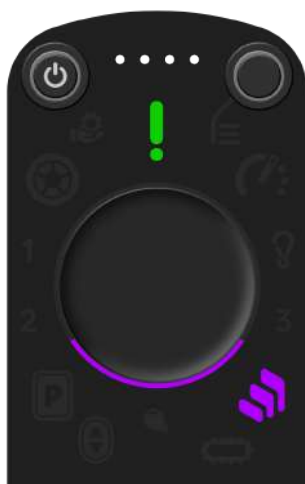
Abbildung 59. Der grüne Hinweis-Indikator zeigt, dass das Treppen-Ende erkannt und das Stützsystem ausgefahren wurde. Wenn Du weiter nach vorne fährst, verschwindet der grüne Hinweis-Indikator. Jetzt bist Du genügend weit von der Treppe entfernt und kannst in den Fahrmodus wechseln.
