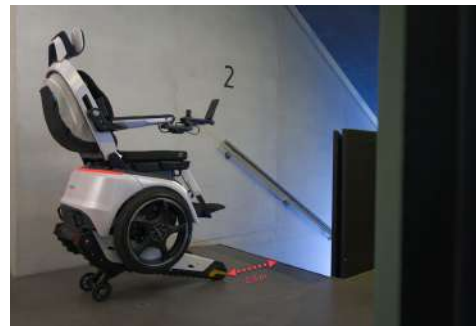
Abbildung 58. Aktiviere den Fahr- oder den Treppenmodus immer mit mindestens 50 cm Abstand zur oberen Treppenkante!
