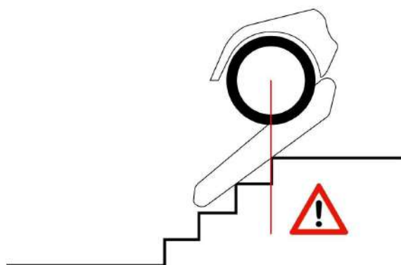
Abbildung 55. Wenn die Mitte der Radachse die Kante der obersten Stufe erreicht hat, muss spätestens der Übergang zur oberen Ebene manuell ausgelöst werden!
