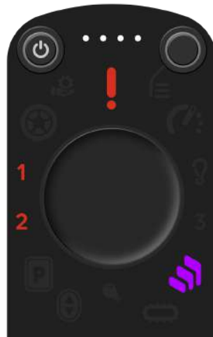
Abbildung 65. Anzeige des Sensoren-Fehlers auf der Steuerkonsole beim Treppensteigen
