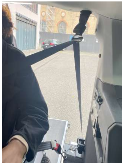
Abbildung 75. Korrekte Gurtführung des 3-Punkt-Gurtes zur Sicherung des Benutzers
