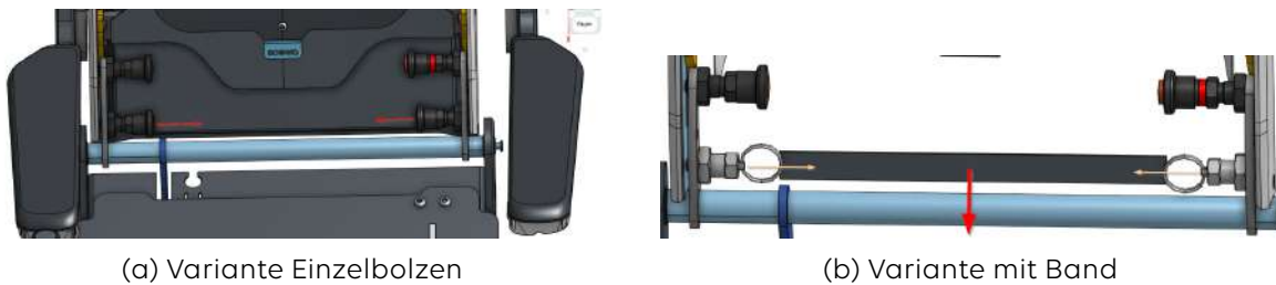
Abbildung 10. Zu entriegelnde Rastbolzen um Rückenlehne zu klappen
