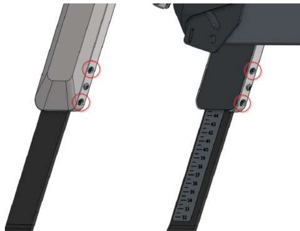
Abbildung 17. Stellschrauben für die Beinstützen-Längeneinstellung
