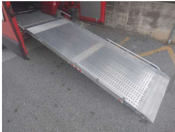
Abbildung 73. Gefährliche, steile Klapprampe mit Schwellen oben
