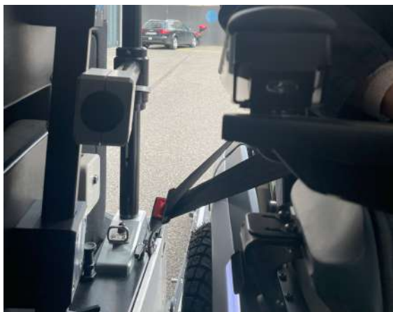
Abbildung 75. Korrekte Gurtführung des 3-Punkt-Gurtes zur Sicherung des Benutzers
