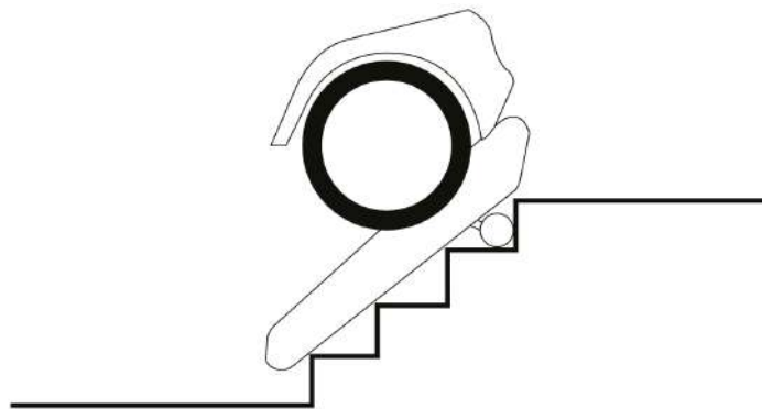
Abbildung 66. Fehlererkennung mitten auf der Treppe
