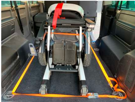
(a) Sicherung vorne
