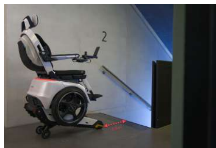
Abbildung 54. Aktiviere den Fahr- oder den Treppenmodus immer mit mindestens 50 cm Abstand zur oberen Treppenkante!
