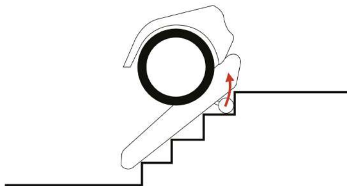
Abbildung 67. Automatische Erkennung von einer weiteren Stufe
