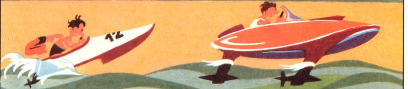
Das Gleitboot dagegen wird wie das Brett der Wellenreiter aus dem Wasser herausgehoben. Der Widerstand wird kleiner, und die Geschwindigkeit vergrößert sich
