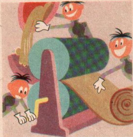
Die Kunststoffe mit Weichmacherzusatz können durch Walzen zu Folien von verschiedener Stärke verarbeitet werden. Die etwas stärkeren und glatten wird man als Fußbodenbelag verwenden und diejenigen, die durch besondere Walzen ein eingepreßtes Muster erhalten haben, begegnen uns als Handtaschen oder Möbelbezüge wieder. Ganz dünne Folien sieht man oft als Vorhänge.
