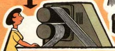
Die so entstandenen Fäden werden zu einem Band zusammengefaßt und über einen Walzenstuhl der Bandstraße zugeführt, wo sie auf das Mehrfache ihrer ursprünglichen Länge ver-
