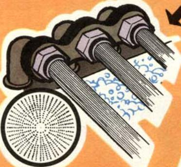
Bis zu 4000 Bohrungen von wenigen hundertstel Millimetern Durchmesser weisen die Spinnköpfe auf, aus denen die stark erhitzte Spinnlösung gepreßt wird.
