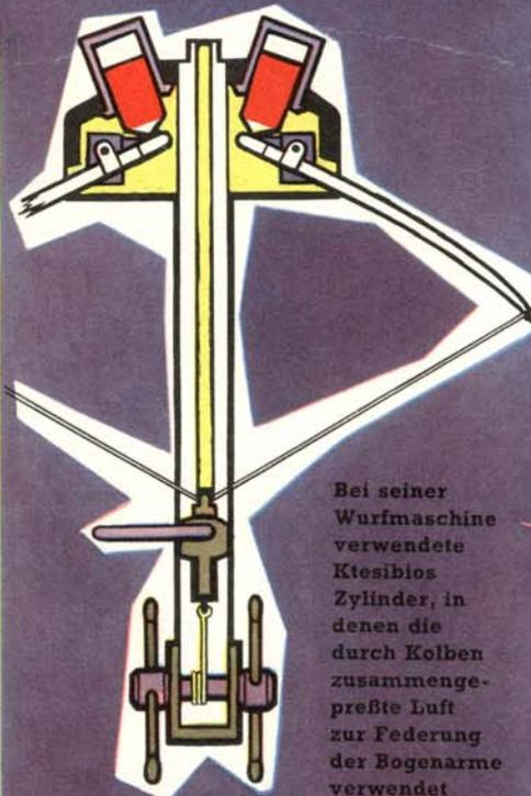
Bei seiner Wurfmaschine verwendete Ktesibios Zylinder, in denen die durch Kolben zusammengepreßte Luft zur Federung der Bogenarme verwendet wurde.
