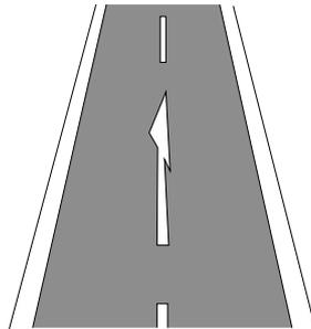
Der Vorankündigungspfeil kann eine Fahrstreifenbegrenzung ankündigen oder das Ende eines Fahrstreifens anzeigen.
