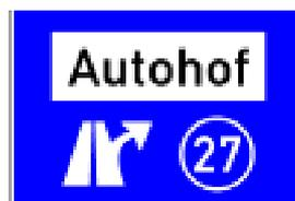
Der Autohof wird einmal am rechten Fahrbahnrand 500 bis 1000 m vor der Ankündigungstafel (Zeichen 448) angekündigt. Auf einem Zusatzschild wird durch grafische Symbole der Leistungsumfang des Autohofs dargestellt.
