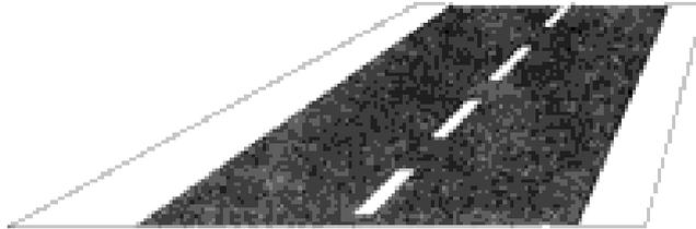
Sie besteht in der Regel aus gleich langen Strichen mit gleichmäßigen Abständen. Eine Leitlinie kann auch als Warnlinie ausgeführt werden; bei der Warnlinie sind die Striche länger als die Lücken.
