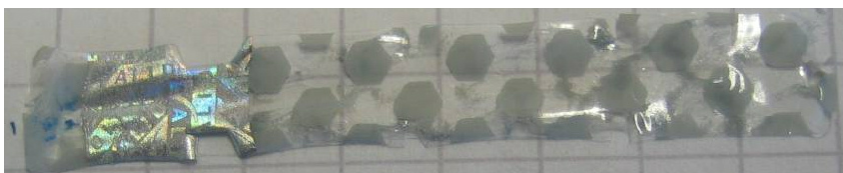
Beschädigtes Siegel mit Schachbrettmuster
